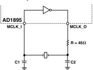
Figure 9a. Fundamental-Mode Circuit Configuration
