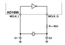
Figure 9a. Fundamental-Mode Circuit Configuration
