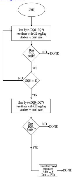
$<sup>^{\</sup>mbox{\tiny $k$}}$  DQ6 rechecked even if DQ5 = 1 because DQ6 may stop toggling when DQ5 changes to 1.
