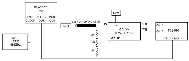
Fig. 1 Test Setup
