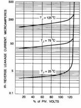
Fig. 5 - TYPICAL REVERSE CHARACTERISTICS
