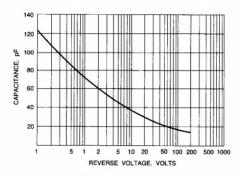
Fig. 6 - TYPICAL JUNCTION CAPACITANCE
