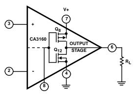
FIGURE 1B. SINGLE POWER SUPPLY OPERATION FIGURE 1. CA3160 OUTPUT STAGE IN DUAL AND SINGLE POWER SUPPLY OPERATION
