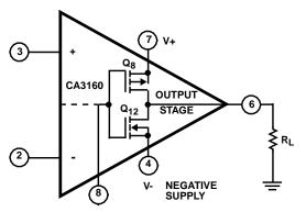
FIGURE 1A. DUAL POWER SUPPLY OPERATION
