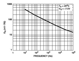
FIGURE 22. EQUIVALENT NOISE VOLTAGE vs FREQUENCY
