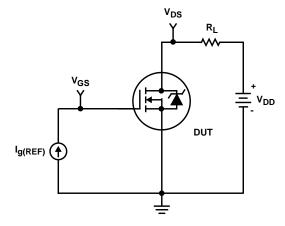
FIGURE 16. GATE CHARGE TEST CIRCUIT
