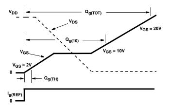
FIGURE 17. GATE CHARGE WAVEFORMS
