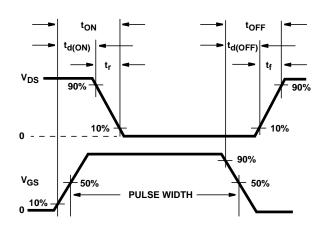
FIGURE 15. RESISTIVE SWITCHING WAVEFORMS
