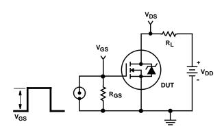
FIGURE 14. SWITCHING TIME TEST CIRCUIT
