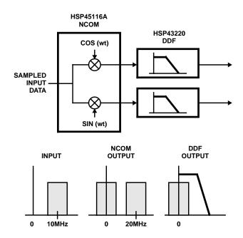
FIGURE 6. CHANNELIZED RECEIVER CHIP SET
