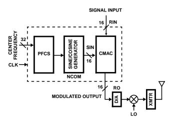
FIGURE 4. AMPLITUDE MODULATION
