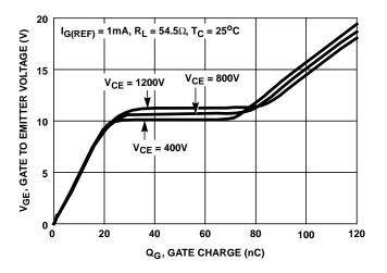
FIGURE 14. GATE CHARGE WAVEFORMS
