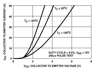
FIGURE 6. COLLECTOR TO EMITTER ON-STATE VOLTAGE
