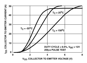
FIGURE 5. COLLECTOR TO EMITTER ON-STATE VOLTAGE
