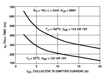
FIGURE 12. FALL vs COLLECTOR TO EMITTER CURRENT
