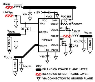
FIGURE 11. PRINTED CIRCUIT BOARD POWER PLANES AND ISLANDS
