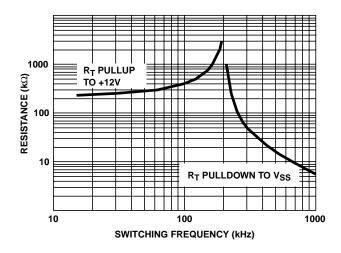
FIGURE 4. R<sub>T</sub> RESISTANCE vs FREQUENCY
