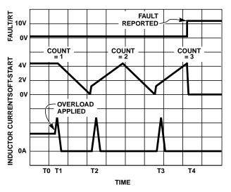
FIGURE 8. OVER-CURRENT OPERATION
