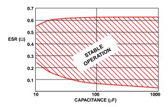
FIGURE 14. C<sub>OUT2</sub> OUTPUT CAPACITOR
