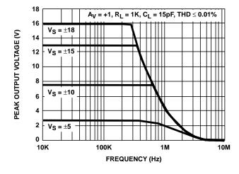
FIGURE 27. OUTPUT VOLTAGE SWING vs FREQUENCY
