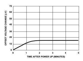
FIGURE 16. OFFSET VOLTAGE WARM-UP DRIFT
