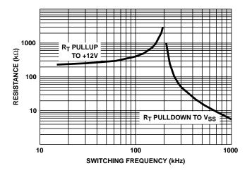
FIGURE 1. RT RESISTANCE vs FREQUENCY
