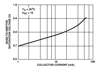
FIGURE 4. BASE-TO-EMITTER SATURATION VOLTAGE vs COLLECTOR CURRENT
