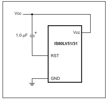
Figure 18. Power-On Reset Circuit
