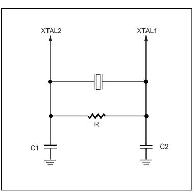
Figure 23. For High Speed (> 24 MHz)
