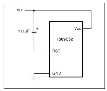
Figure 22. Power-On Reset Circuit
