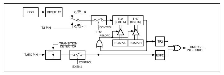
Figure 13. Timer 2 in Auto-Reload Mode
