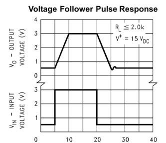
FIGURE 8. VOLTAGE FOLLOWER PULSE RESPONSE (SMALL SIGNAL)
