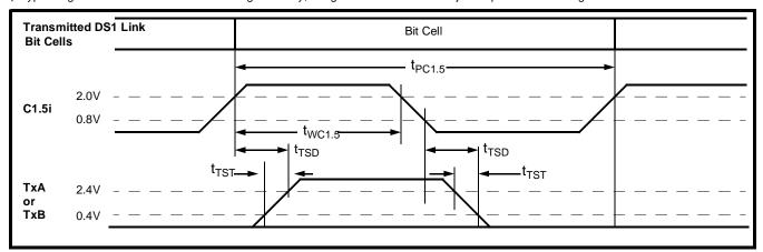
Figure 19 - Transmit Timing for DS1 Link
