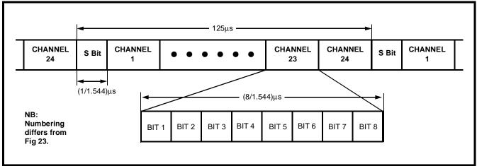
Figure 24 - DS1 Link Frame Format
