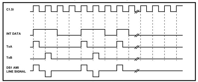
Figure 5 - DS1 Transmit Timing
