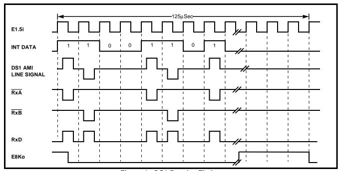
Figure 4 - DS1 Receive Timing
