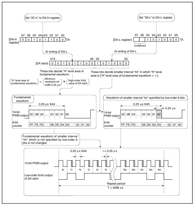
Fig. 19. 14-bit PWM Output Example (f(XIN) = 8MHz)
