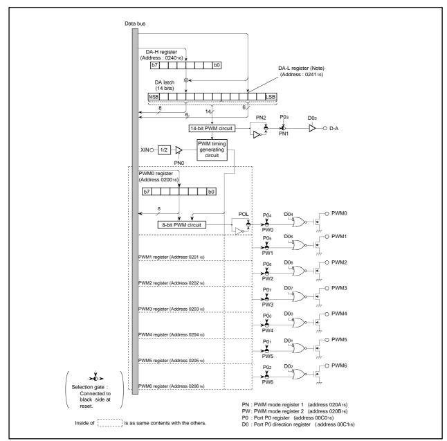
Fig. 17. PWM Block Diagram
