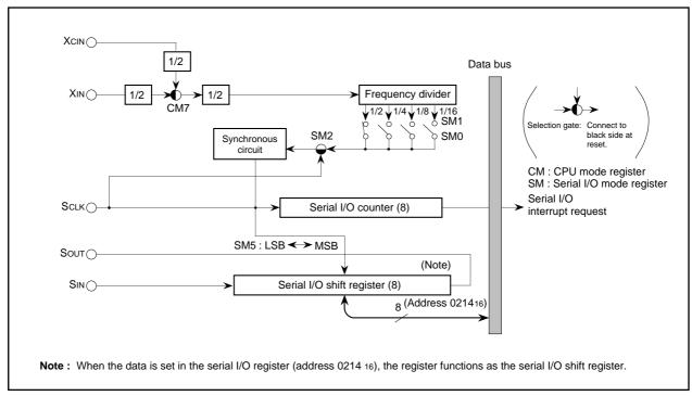
Fig. 14. Serial I/O Block Diagram
