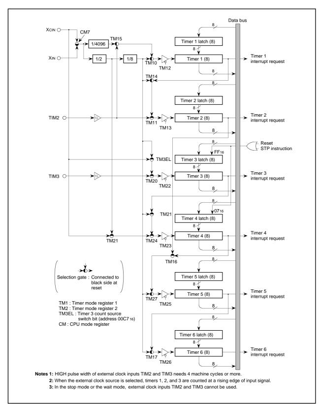
Fig. 13. Timer Block Diagram
