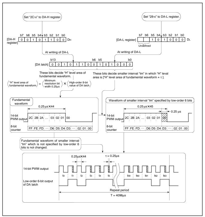
Fig. 25. 14-bit PWM output example (f(XIN) = 8 MHz)
