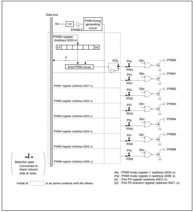
Fig. 15. PWM block diagram
