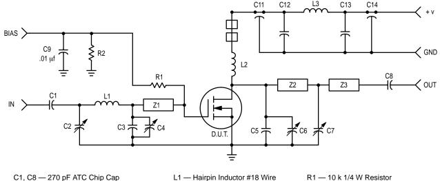
C1, C8 — 270 pF ATC Chip Cap C2, C4, C6, C7 — 1.0–20 pF Trimmer Cap C3 — 15 pF Mini Unelco Cap C5 — 33 pF Mini Unelco Cap C9, C12 — 0.1  $\mu$ F Ceramic Cap C11, C14 — 680 pF Feed Thru Cap C13 — 50  $\mu$ F Tantalum Cap
