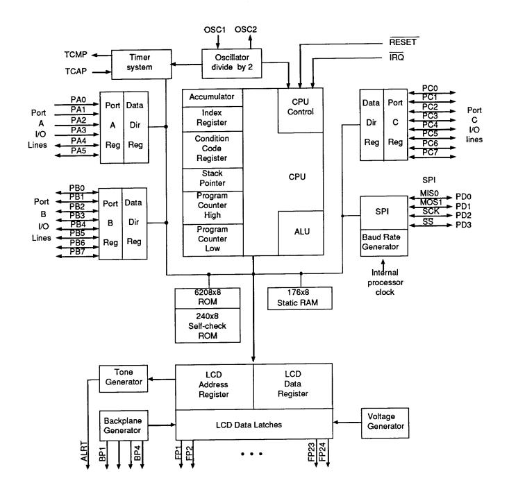
MC68HC05L6 Microcomputer Block Diagram
