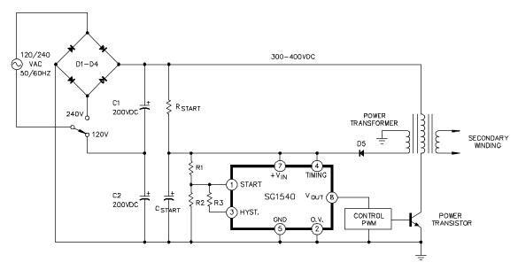
FIGURE 3 - EFFICIENT PRIMARY SIDE START-UP
