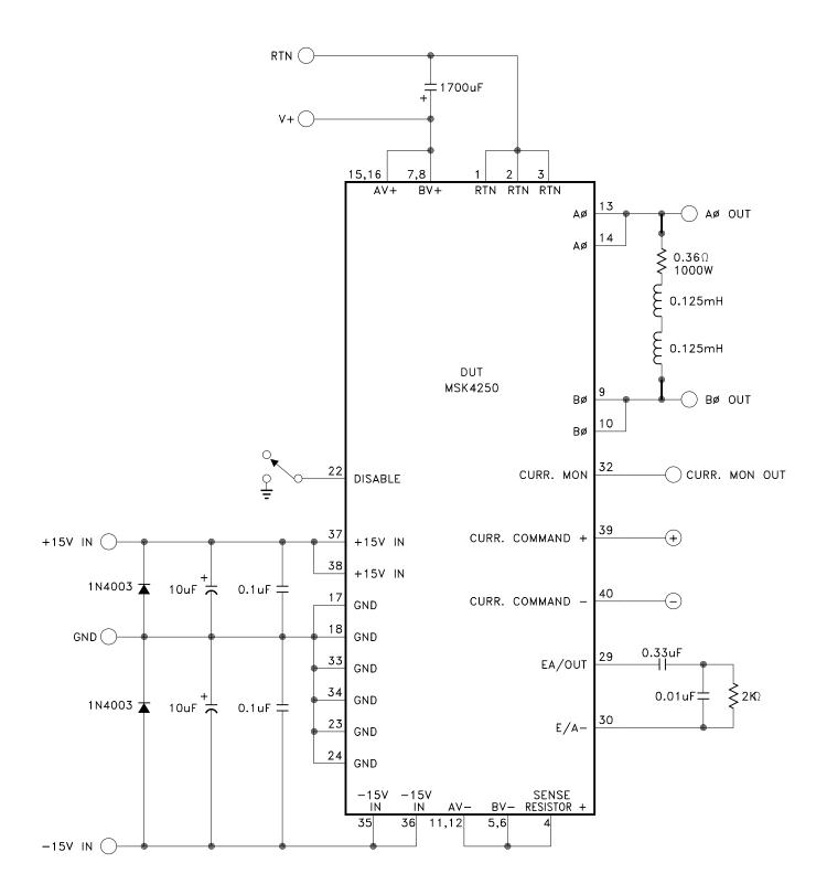
TYPICAL TEST SCHEMATIC
