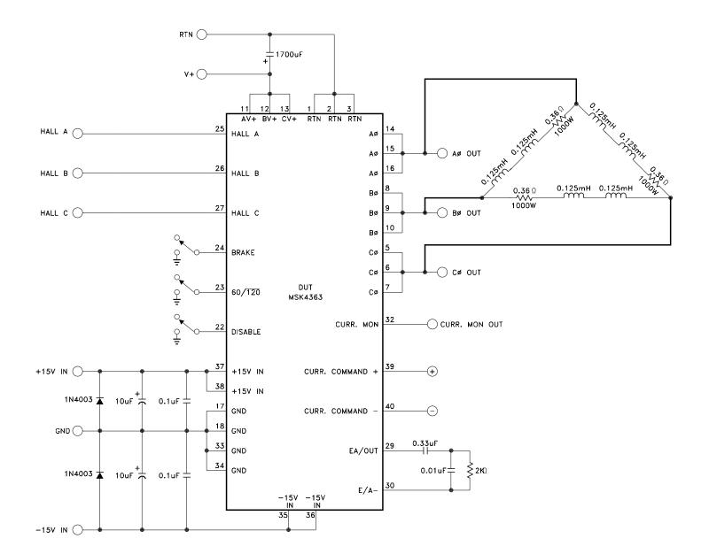
TYPICAL TEST SCHEMATIC
