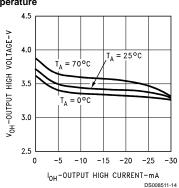
Driver  $\rm V_{OH}$  vs  $\rm I_{OH}$  vs  $\rm V_{CC}$
