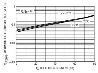
Figure 17. VCE(sat) versus IC
