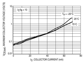
Figure 7. VCE(sat) versus IC
