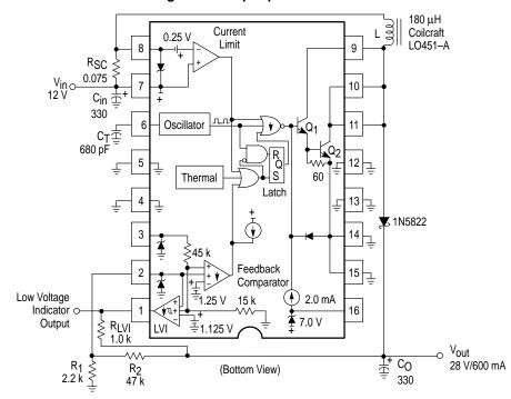
Figure 22. Step–Up Converter
