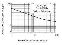
Fig. 6-TYPICAL JUNCTION CAPACITANCE
