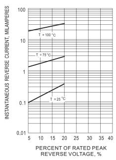
Fig.3- TYPICAL REVERSE CHARACTERISTIC
