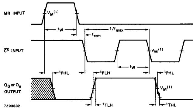
(1) HC :  $V_M = 50\%$ ;  $V_I = \text{GND to } V_{CC}$ .
