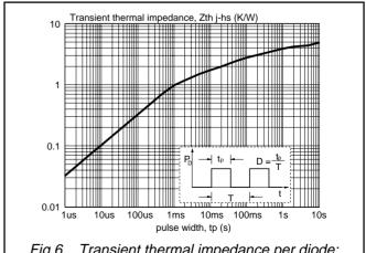
Fig.6. Transient thermal impedance per diode;  $Z_{th j ext{-}hs} = f(t_p)$ .
