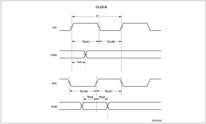
Figure 11. Timing Diagrams (cont.)
