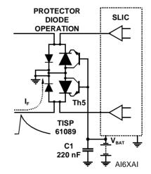
Figure 5. POSITIVE OVERVOLTAGE CONDITION
