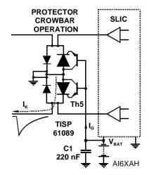
Figure 4. NEGATIVE OVERVOLTAGE CONDITION
