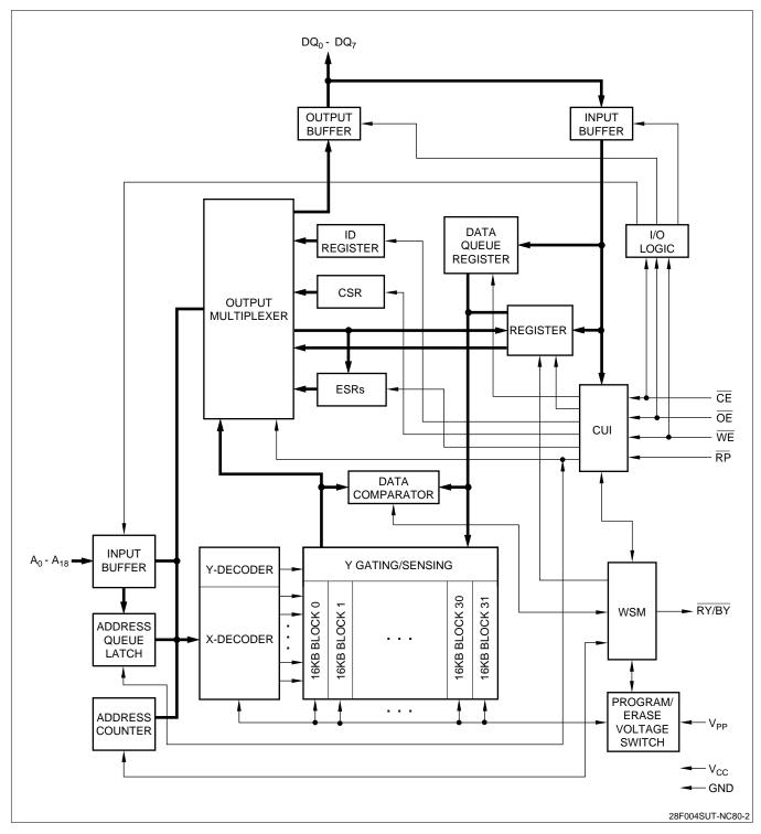
Figure 2. LH28F004SU-NC Block Diagram
