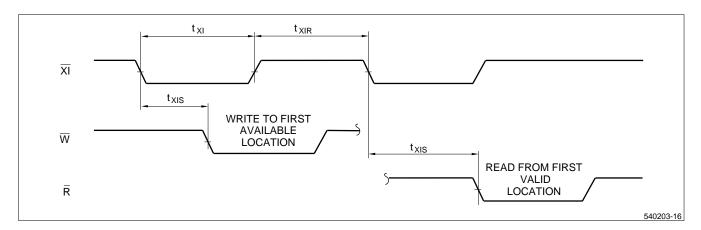
Figure 21. Expansion-In Timing
