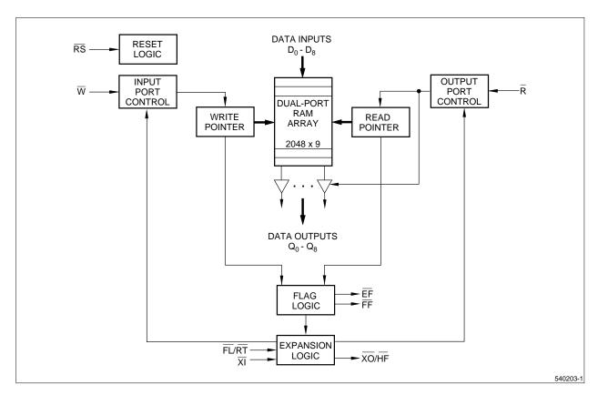
Figure 3. LH540203 Block Diagram
