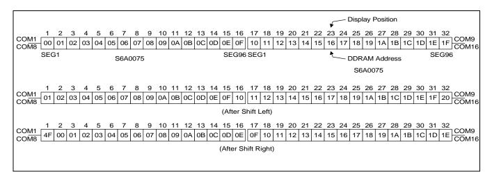
Figure 5. 1-line  $\times$  32ch. Display
