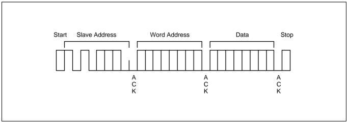
Figure 5-9. Byte Write Operation
