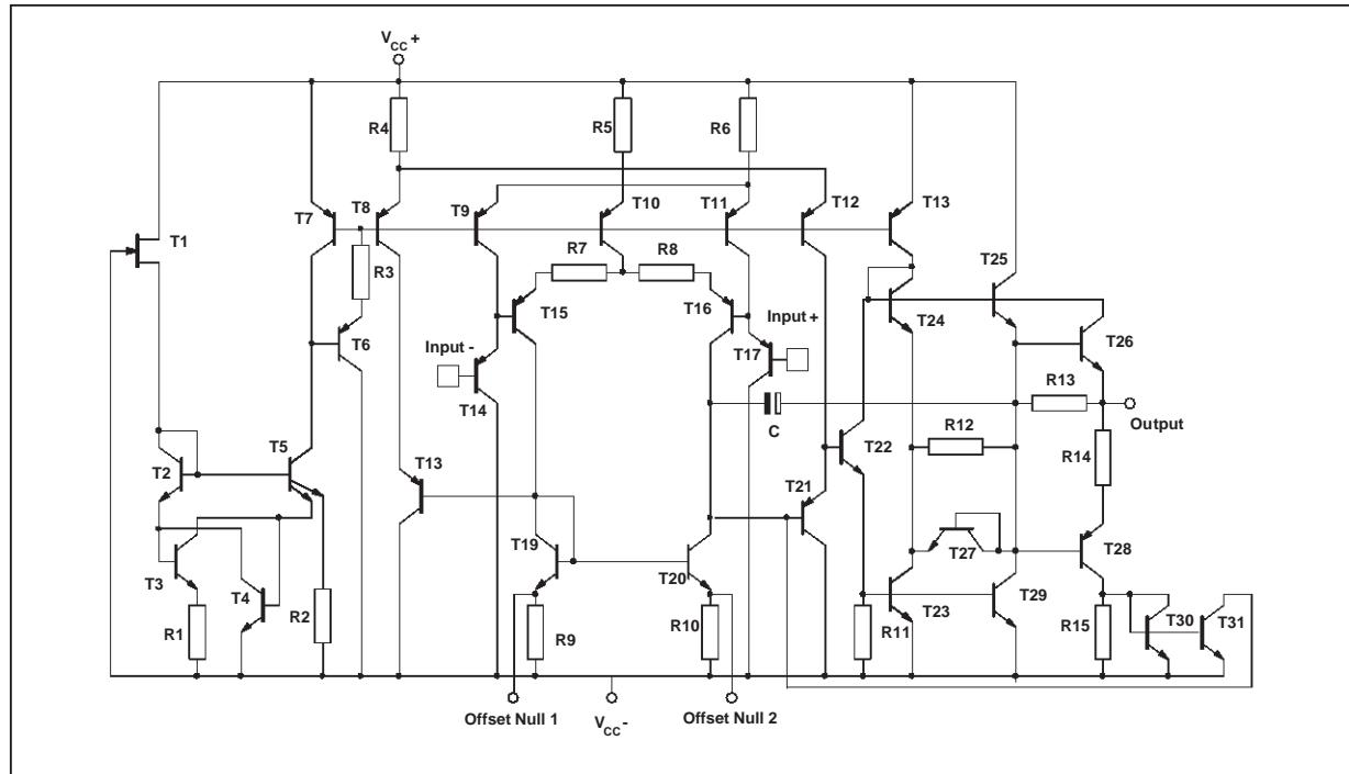
**INPUT OFFSET VOLTAGE NULL CIRCUIT**
