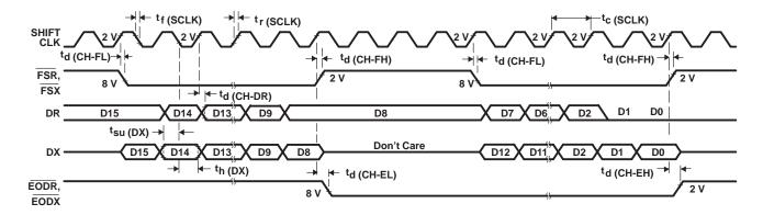
Figure 4-4. Byte-Mode Timing
