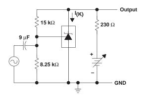
**TEST CIRCUIT FOR VOLTAGE AMPLIFICATION**
