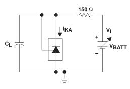
**TEST CIRCUIT FOR CURVE A**
