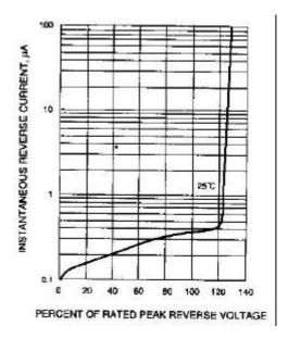
Fig. 3-TYPICAL FORWARD CHARACTERISTICS Fig. 4- TYPICAL REVERSE CHARACTERISTICS
