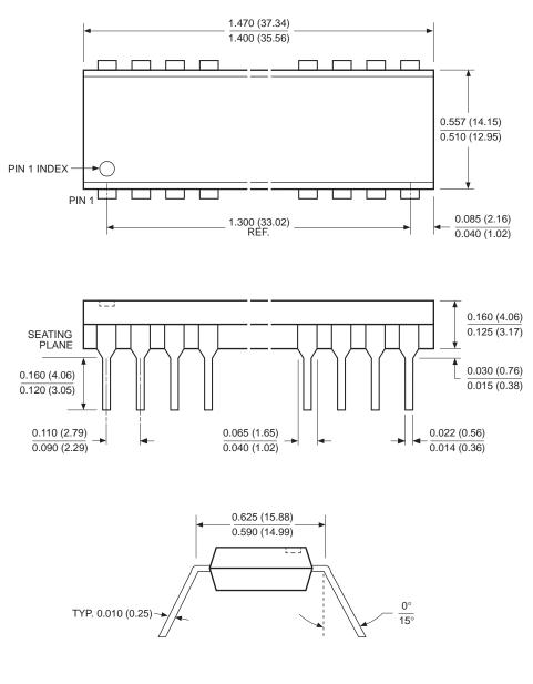
28-LEAD PLASTIC DUAL IN-LINE PACKAGE TYPE P
