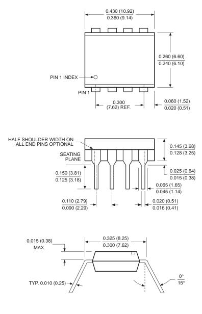
8-LEAD PLASTIC DUAL IN-LINE PACKAGE TYPE P
