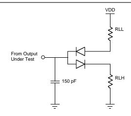
**Test Load Diagram**
